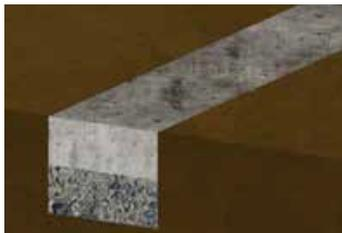
3. Betonbett aus 3 Teile Sand + 1 Teil Wasser + 1 Teil Zement, auf Tragschicht aufbauen.
