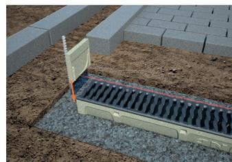
4. Stirnwände aufsetzen.
