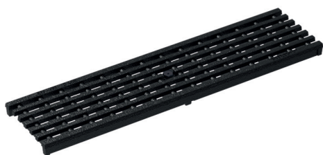
Längsstabrost, Gussisen, KTL beschichtet Belastungsklasse: D400* , Länge: 50 cm, MW 25 x 10 mm
