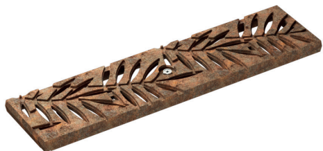
Designrost, LEAF, Gussisen, unbeschichtet Belastungsklasse: C250 , Länge: 50 cm, SW 5 - 9 mm
