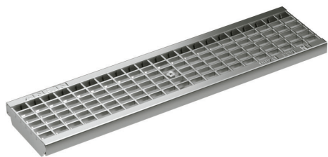
Maschenrost, Stahl verzinkt, Belastungsklassen: B125, C250, D400 , Länge: 50 cm, 100 cm MW 30 x 14 mm / 30 x 10 mm / 20 x 14 mm
