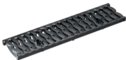
Stegrost, OvalGrip Design, Gussisen, KTL beschichtet Belastungsklassen: F9600 , Länge: 50 cm, SW 10 mm mit RapidLock Verschluss
