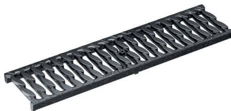
Stegrost, OvalGrip Design, Gusseisen, KTL beschichtet Belastungsklassen: C250, E600* , Länge: 50 cm, SW 10 mm
