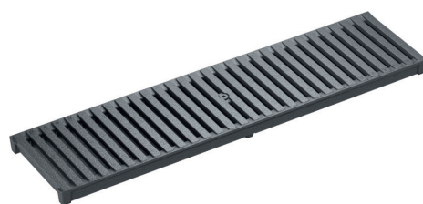
Stegrost, HEELGUARD, Gussisen schwarz lackiert, Gussisen KTL beschichtet Belastungsklasse: D400* , Länge: 50 cm, SW 6 mm
