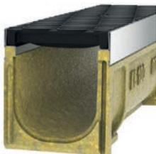
Das optimierte UNILINK®-Fugensystem hebt die traditionelle Unterscheidung von Rinnenanfang und Rinnenende auf. Elemente gleicher Bauhöhe können in beliebiger Ausrichtung zusammengefügt werden. Die symmetrisch geteilten Halfugen ermöglichen die optimale Abdichtung der Stöße. Vertikal ausgerichtete Nuten und Federn unterstützen eine rationelle Verlegung: Die Einbaurichtung kann dabei frei gewählt werden!
