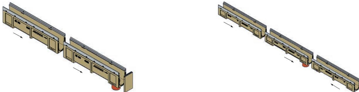
2. Einbau eines Einlaufkastens am Ende oder in der Mitte eines Rinnenstranges.
