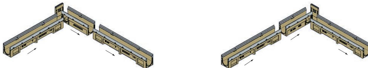
4. T-Verbindung mit mittiger Anordnung des Rinnenelementes mit Vorformung für Anschlussmöglichkeit.
