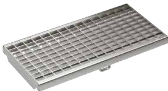
Maschenrost, Stahl verzinkt, Edelstahl Belastungsklassen: C250 Länge: 50 cm, 100 cm, MW 30 x 20 mm
