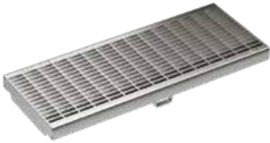
Maschenrost, Stahl verzinkt Belastungsklassen: C250 Länge: 50 cm, 100 cm, MW 30 x 10 mm
