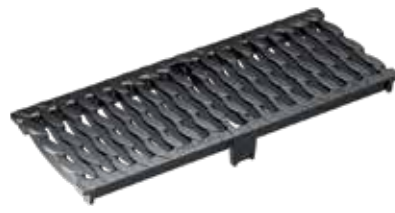
Guss-Stegrost mit OvalGrip Design, Guss GJS, KTL beschichtet Belastungsklassen: D400*, E600* Länge: 50 cm, SW 12 mm
