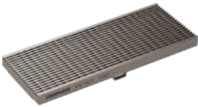
Längsprofilrost, Edelstahl Belastungsklasse: C250 Länge: 50 cm, 100 cm, SW 5 mm
