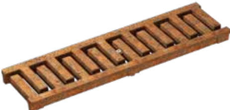
Stegrost, MASSIV 32, Gusseisen unbeschichtet, Gusseisen KTL beschichtet Belastungsklasse: E600* , Länge: 50 cm, SW 11 mm Nur für KE-100 geeignet.
