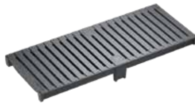
Stegrost, HEELGUARD, Guss GJS, schwarz lackiert Belastungsklasse: D400* Länge: 50 cm, SW 6 mm
